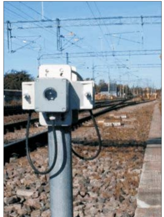
LB 200 - Einweglichtschranke in Gehäuse IP 65
